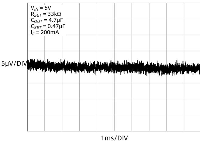
图 5 输出噪声 (10Hz~100kHz)
