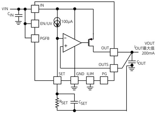
图 11 C<sub>OUT</sub> 和 C<sub>SET</sub> 连接实现稳定性
