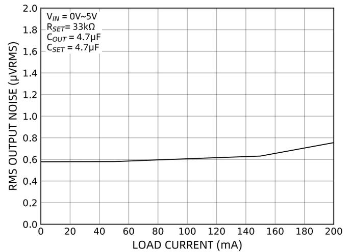
图 4 基准电流 RMS 输出噪声 (10Hz~100kHz)
